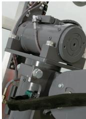
Der enorm starke und robuste **3D-Manipulator** ermöglicht es dem Multilifter Gerenuk® 500 Elemente von bis zu 500 kg waagrecht aufzunehmen und beispielsweise überkopf zu montieren.
