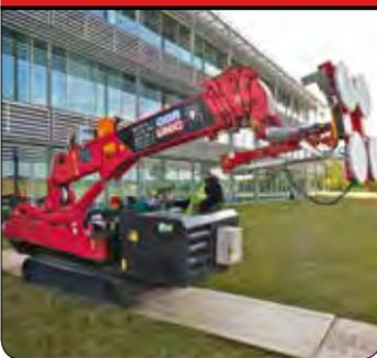
Manipulatoreinheit für Vakuum-Hebezeug
