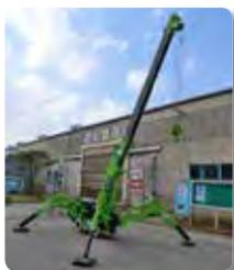
Produktionsstätten, Flughäfen und sauberen Umweltbereichen. Diese einzigartigen Minikrane werden mittels einer wiederaufladbaren 48V-Batterie angetrieben und verfügen über die gleiche starke Tragkraft wie unsere Standardmodelle. Innovative Eigenschaften wie u.a. nichtmarkierender Reifen ermöglichen diesen Kranen auch auf hellen Böden bzw. polierten Oberflächen zu arbeiten.
